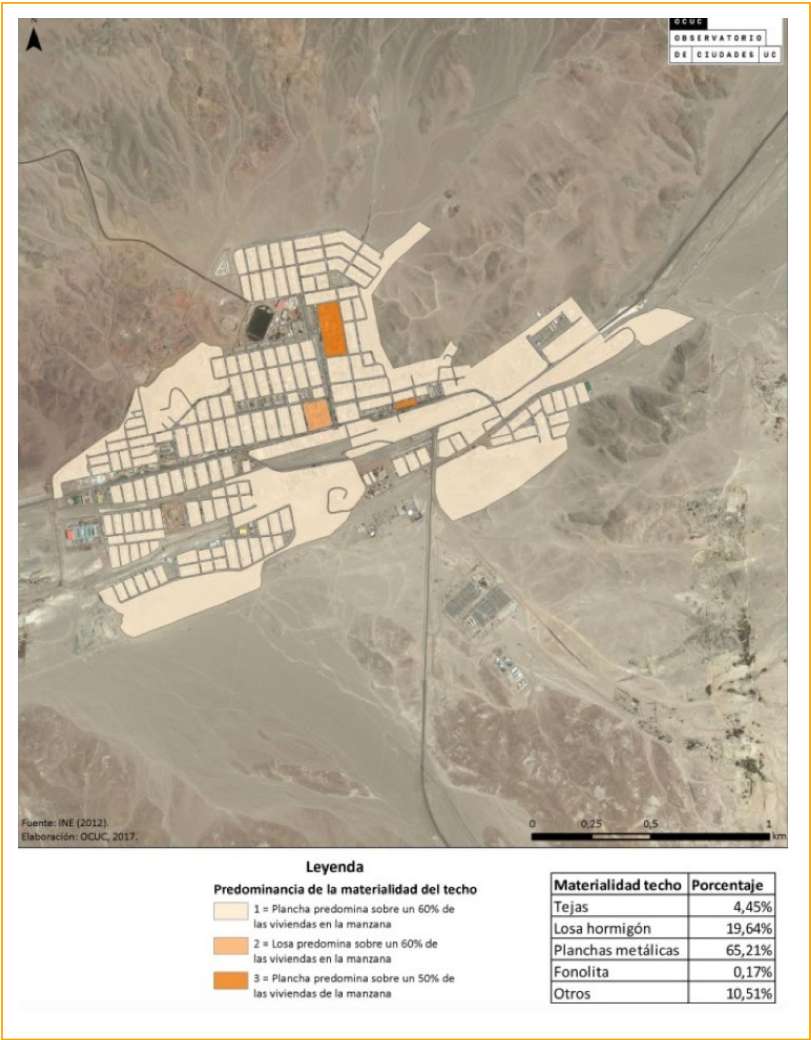
Figura 30: Distribución espacial de materiales utilizados en los techos de las viviendas de Diego de Almagro, fuente Observatorio de Ciudades UC, 2017
